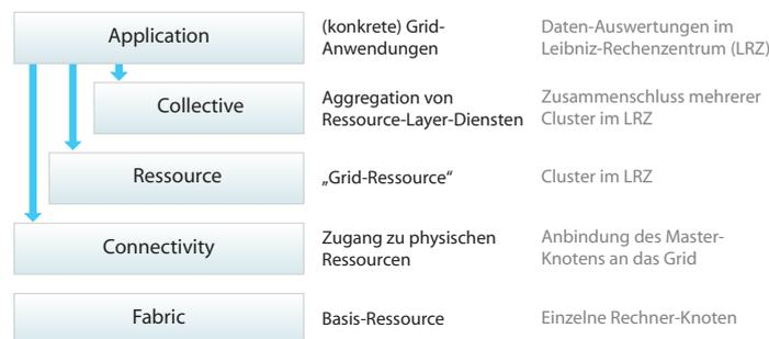
Abbildung 2.3: Die verschiedenen Schichten des Grid-Layer-Stacks nach [FKT01]
