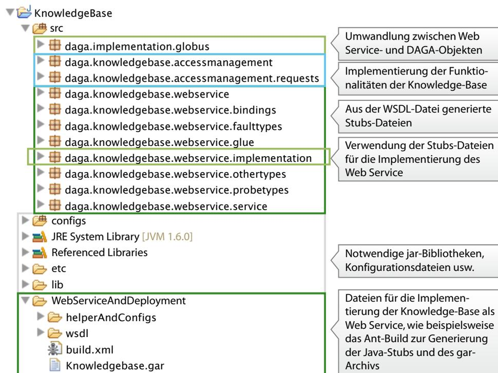
Abbildung 7.3: Verzeichnis-Struktur des Eclipse-Projekts der Knowledge-Base
