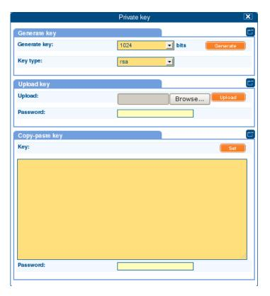
Abbildung 4.4.: Generieren oder Hochladen eines privaten Schlüssels für die SCB
