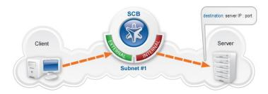
Abbildung 2.1.: SCB im Bridge-Modus [Bal11]
