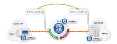
Abbildung 2.2.: SCB im Router-Modus [Bal11]
